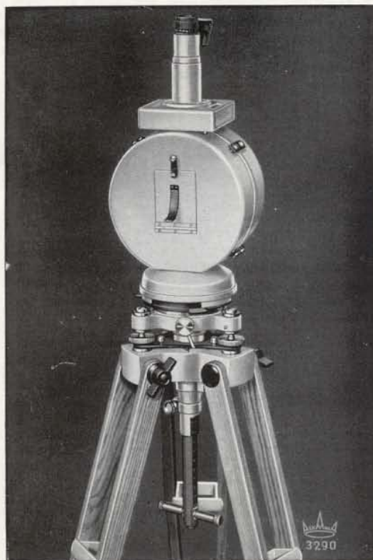
Fig. 2 - Balanza magnética vertical sobre trípode (aprox. 1/5 del tamaño natural)
