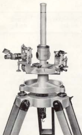
Fig. 6 - Teodolito Magnético de Viaje con dispositivo suplementario de magnetómetro horizontal de torsión (HTM)
