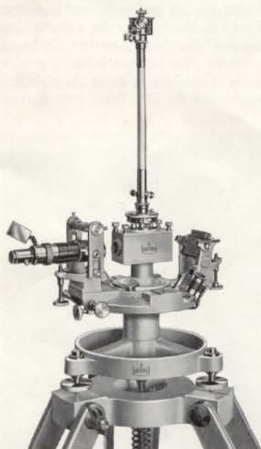
Fig. 2 - Teodolito Magnético de Viaje con dispositivo suplementario de declinatorio de suspensión de hilo
